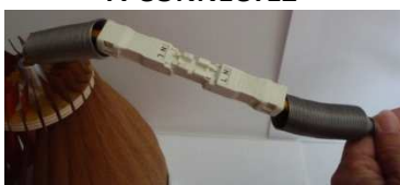
2-Insérez le connecteur mâle dans le connecteur femelle jusqu'à entendre un « clic »
